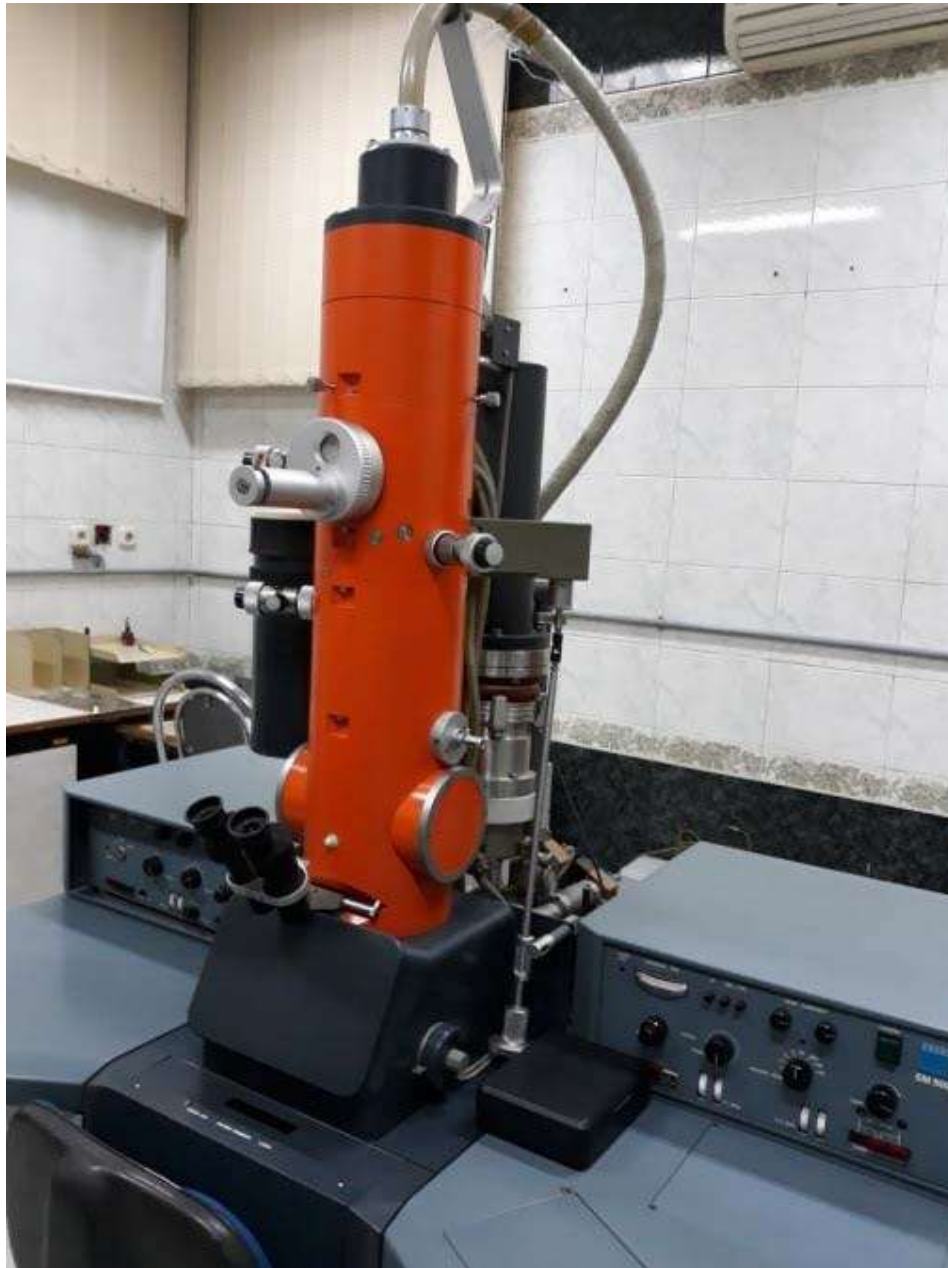
دستگاه ترامیکروتوم (Ultramicrotome) مدل UC6 ساخت شرکت Leica آلمان
